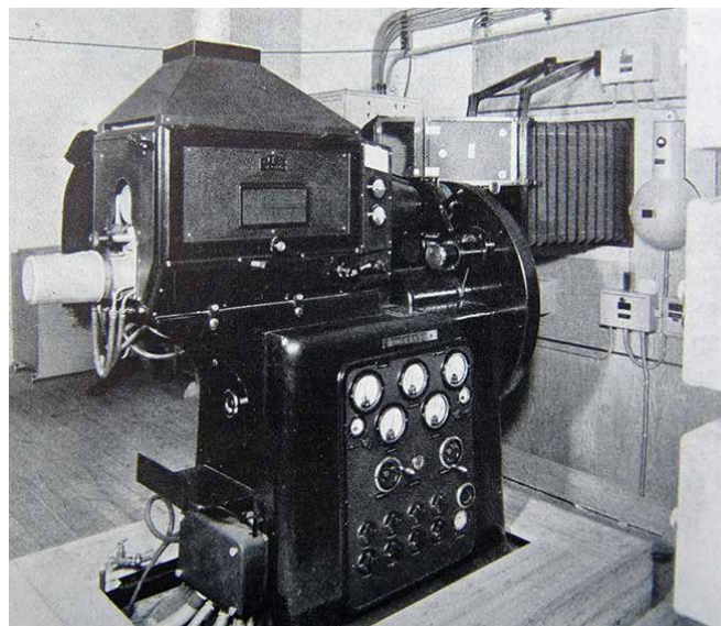
Lichtstrahlabtaster für Fernsprechverkehr Leipzig, 1936
