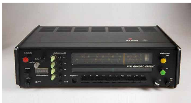
Das HiFi-Steuergerät rk8 sensit von Heliradio ist komplett mit Silizium-Transistoren bestückt, Baujahr 1978 (*) Foto: G. Roleder
