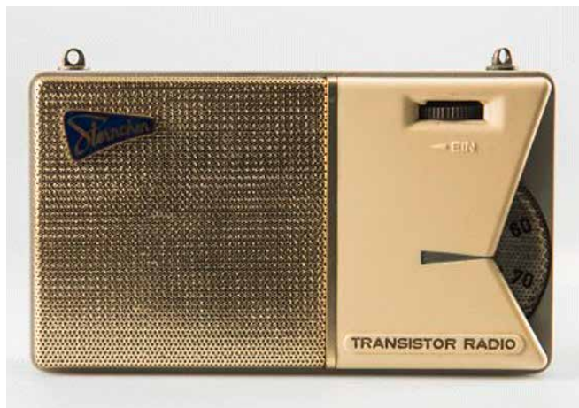
Das ab 1959 hergestellte Taschenradio „Sternchen“ aus dem VEB Stern-Radio Sonneberg war das erste Transistorgerät der DDR (*) Foto: G. Roleder
