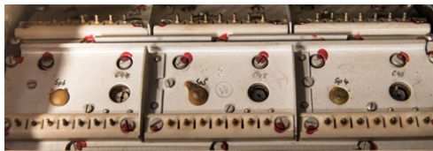
Teilansicht des Wellenschalters; oben und unten jeweils 21 Kontaktstifte
