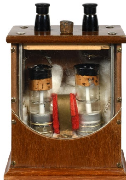
Weston-Normalelement geöffnet (Bild: Wissenschaftliche Sammlung Alexander Kudas)
