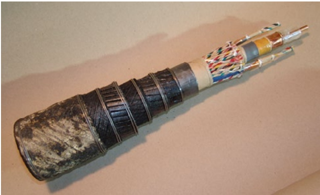
Breitband-Fernkabel FK 501, abgesetzt
