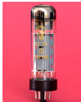
(* EL34 aus dem VEB Röhrenwerk Mühlhausen mit jeweils vier Schränk schlitzen rechts und links (Foto: G. Roleder)
