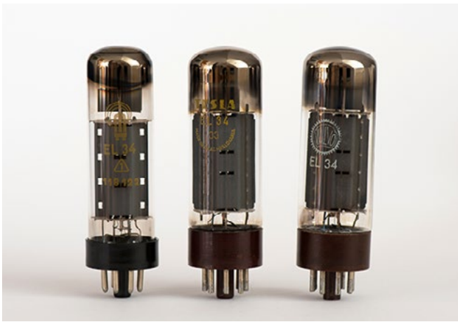
(*) EL34 von RFT, Tesla und Valvo; im Unterschied zu RFT sind bei Tesla und Valvo die Anodenbleche durch Punktschweißung verbunden (Foto: G. Roleder)
